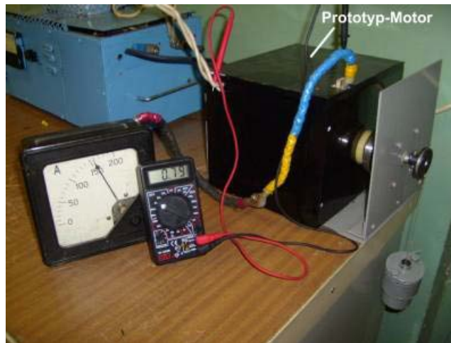
Foto der Laboraufbau einschließlich Motor entwickelt Prototyp
